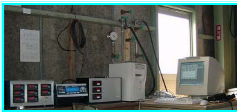
屋外試験時使用のラインアップ 左より管表面温度用調節計(8点)、圧力計(分解能17ビット)、周囲温度湿度(管内温度)、 Visual Basic用 Windowsパソコン
